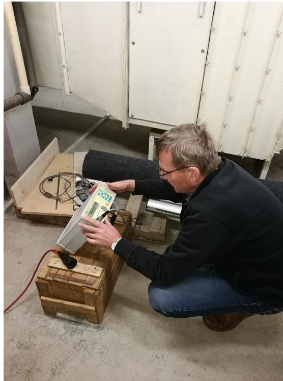
Ultraschalldurchflussmengenmessung zur Bedarfsermittlung
