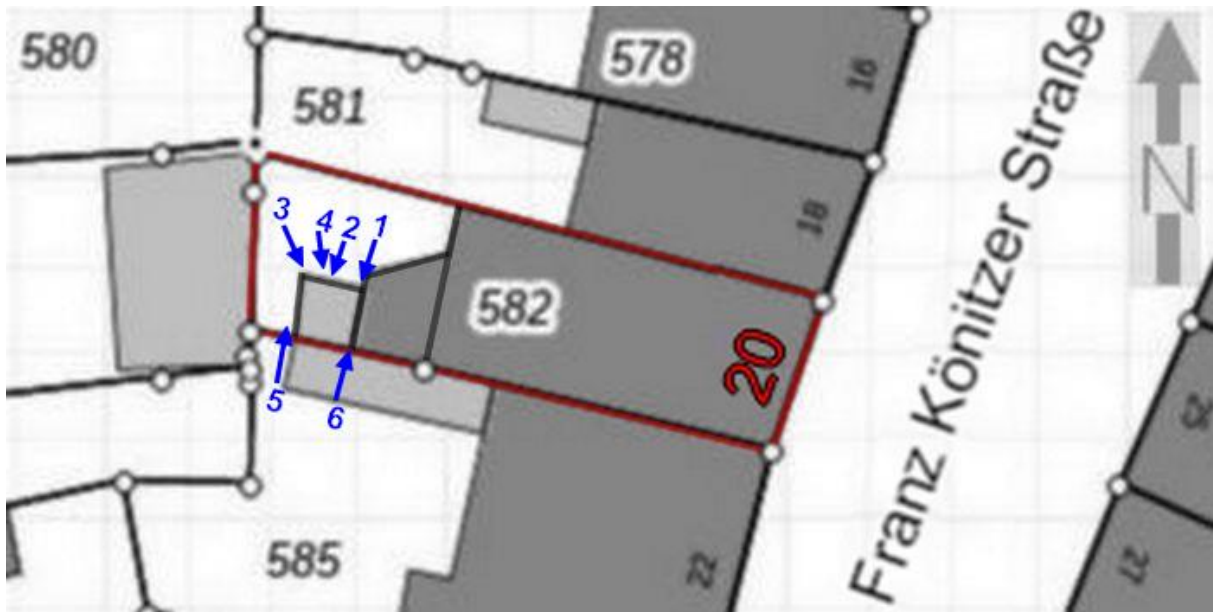
Abbildung 16 – Lageplan des Grundstücks Franz-Könitzer-Straße 20 mit Gebäuden. Orte mit neuen Rissbildungen nach Komar (2021, S. 9) in blau. (Ergänzter Ausschnitt aus Flurkarte).
