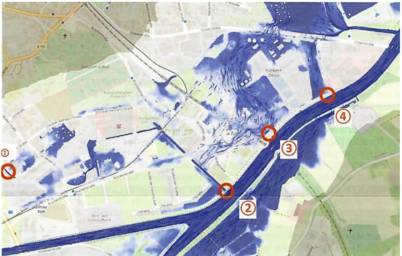
Abb.05 Übersicht der überfluteten Flächen bei HQ (100) mit Nummerierungen der zu untersuchenden Stellen sowie Visualisierung der Strömungsrichtung (blaue Fließpfeile), Landestalsperrenverwaltung Sachsen (LTV)
